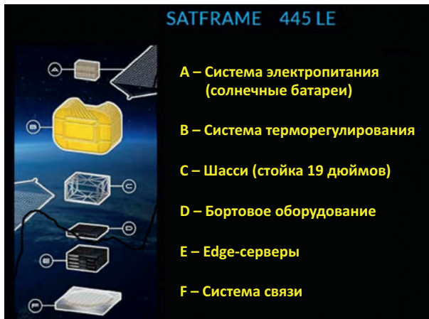
Рис. 3.▲ Компонентный состав космического микроЦОДа SatFrame
